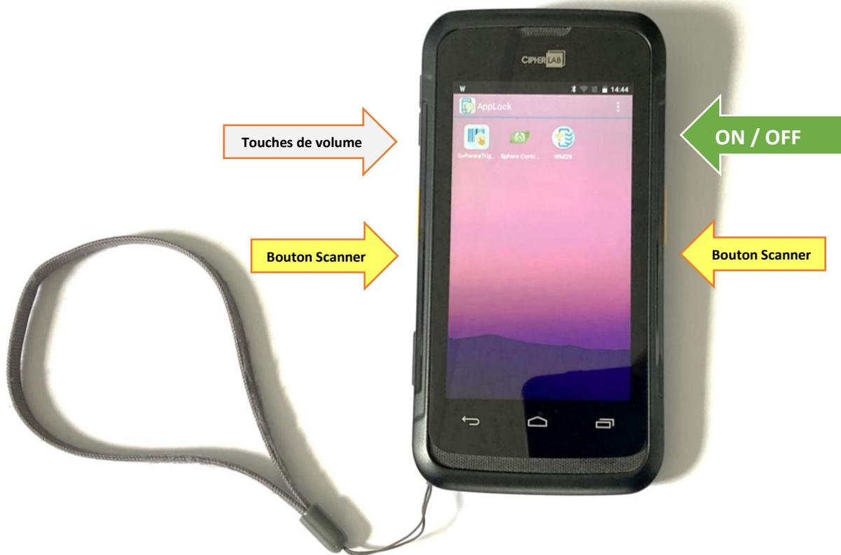
**Attention** : Lors de la mise sous tension, **VEILLEZ à ne pas appuyer simultanément** sur la touche **ON/OFF** et les touches de volume situées sur le côté gauche de l'appareil.
