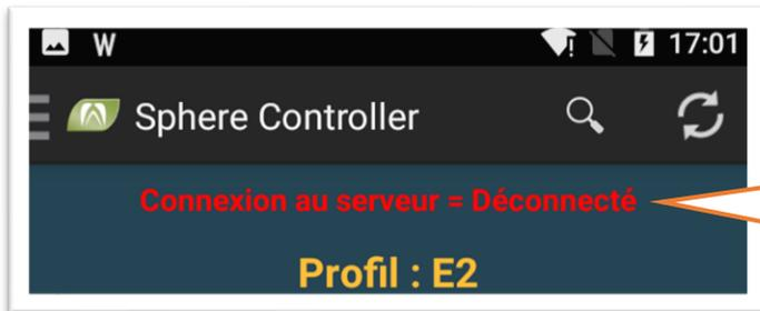
La **connexion est défectueuse**, le scanner n'est plus opérationnel, il faut appuyer sur le bouton de reconnexion
